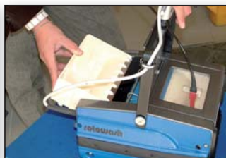
SERBATOIO POSTERIORE PER RACCOLGERE AUTOMATICAMENTE L'ACQUA SPORCA
